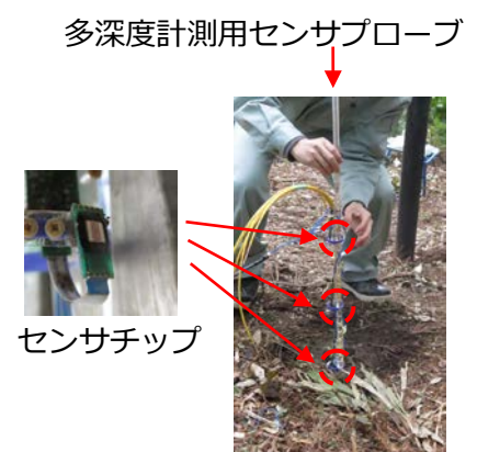
図2 山の斜面への設置風景 (設置協力：静岡県浜松市、(株)アサノ大成基礎エンジニアリング)
