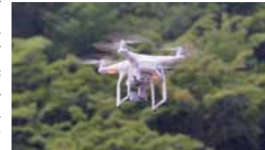
UAV(所謂ドローン)を使って、土石流発生前後の地形変化を計測しています。
