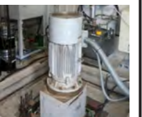
人工震源装置: 中央の巨大なモーターで地下の錘を回転させて遠心力で地震波を発生する。
