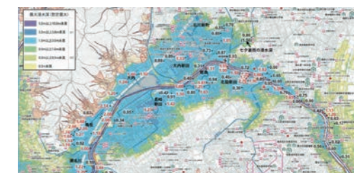
2022年9月24日に発生した静岡市巴川流域の洪水の浸水深(m)
