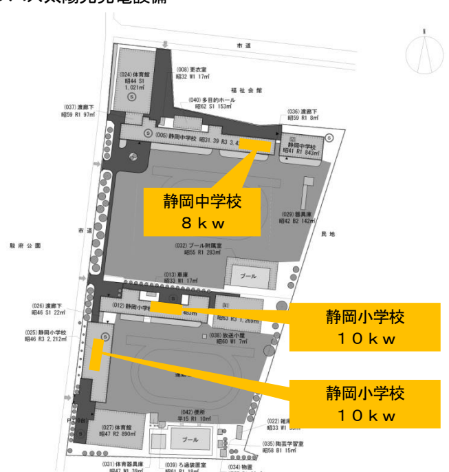
図 7-5-3 駿府キャンパス太陽光発電設備
