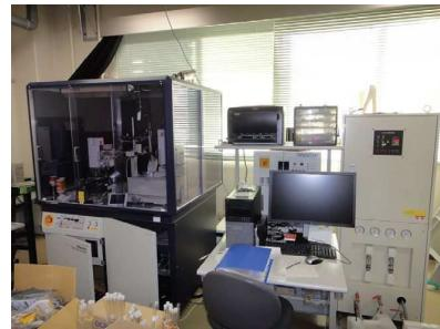
微小結晶用X線構造解析装置
