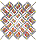
分子を規則的に並べ、リチウムイオンが規則的に配列するための「道」を持つ結晶の構造。「道」に配列されたイオンが伝導パスとなることで電子が素早く移動できる。
