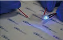
開発した透明電極を使って青色LEDが点灯している様子
