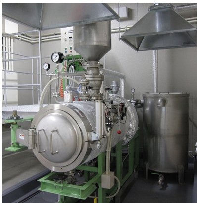
(内容積300リットル) 水熱粉末燃料化装置
