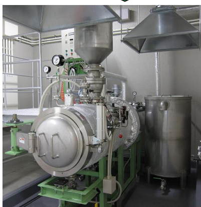
(内容積300リットル) 水熱粉末燃料化装置
