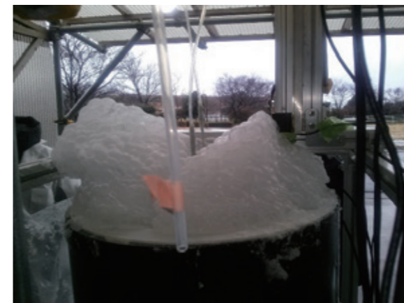
図4: タンクから溢れるオゾンフォーム(粘土化合物等が表面に付着)
