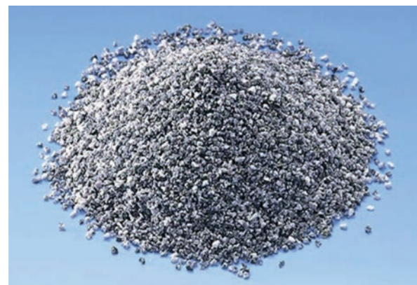
写真1.溶融スラグの外観
