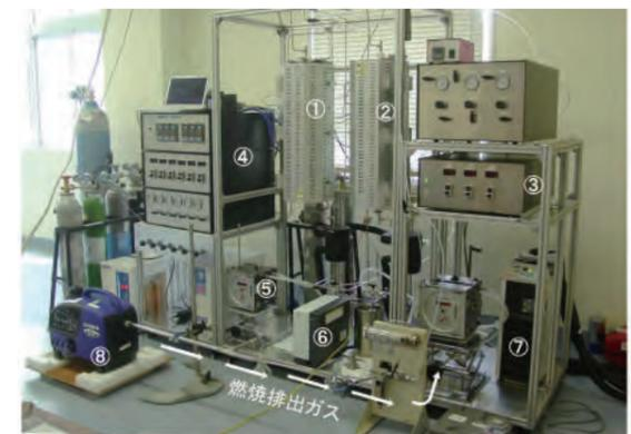
写真1.ラボレベルのCO<sub>2</sub>排ガス処理装置
