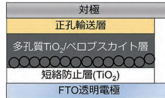
図2.ペロブスカイト太陽電池の構造の概略
