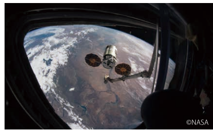
▲ISSのロボットアームにキャプチャされた補給船 NG-15/Cygnus
