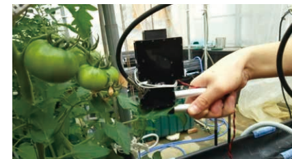
反射パターンの計測 計測器にはハロゲンランプが内蔵されており、このランプから照射される光の反射パターンを計測している。
