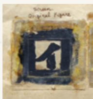
撮像実験に使用された「イ」の字の雲母板
