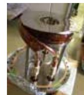
PLD装置の真空中容器内に組み込んだ電磁石
