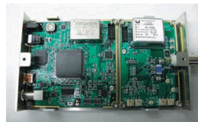
高ダイナミックレンジデジタルフォトンカウンティングX線検出器。
