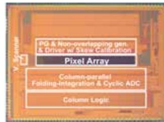
短パルス光源と高速電荷変調素子(LEFM)を用いた独自のTOF計測手法と、参照光サンプリング、列並列スキュー補正回路により、100μmを超える高距離分解能化を達成
